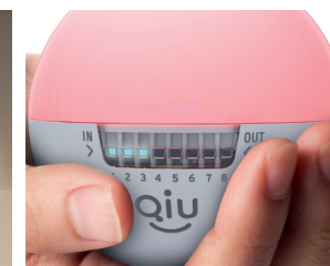
Obere Halbkugel: Biofeedback (rot/grün); blaue LEDs: Atmungs- vorgabe
